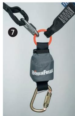
Das Verbindungsmittel ist einsträngig und kann mittels Zusatzstrang Typ WRE-02A10 (ohne eigenen Bandfalldämpfer) zum Y-Verbindungsmittel erweitert werden **7**.
